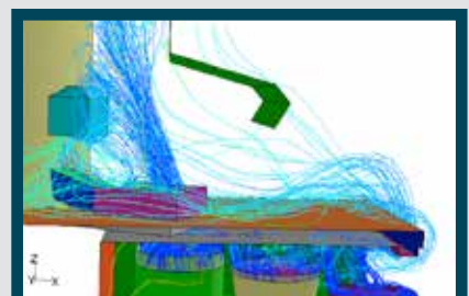
Modellering av røykfordeling i tappe-området ved bruk av CFD.
